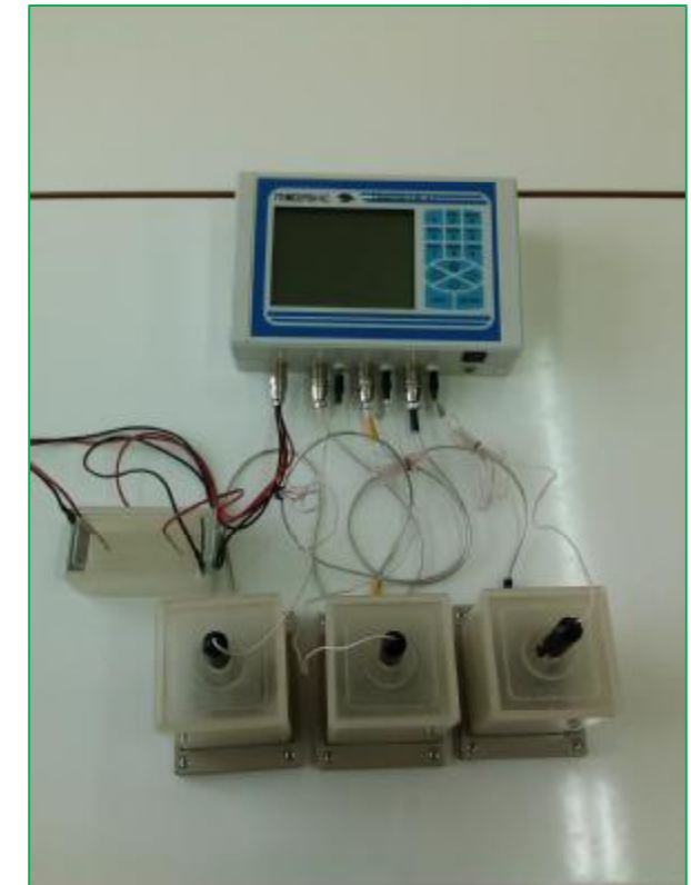
ПРИБОР ДЛЯ ОПРЕДЕЛЕНИЯ КОРРОЗИОННОЙ АГРЕССИВНОСТИ ГРУНТОВ «ОКА»
